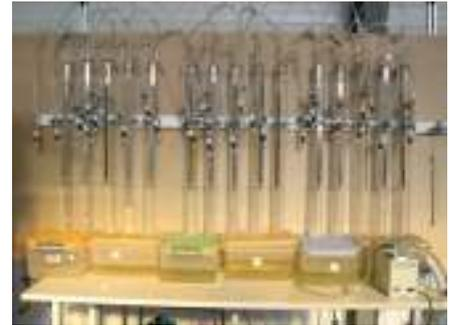
*\* Le fait de travailler sur des volumes de réacteurs importants permet de valider la biodégradabilité anaérobie de l'échantillon. Nous pouvons ainsi travailler sur une granulométrie représentative du déchet en fonctionnement industriel. De même le choix d'un inoculum adapté consolide la représentativité de la mesure effectuée.*
