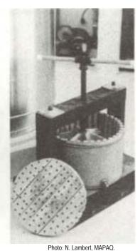
Figure 3: Presse à opercules
