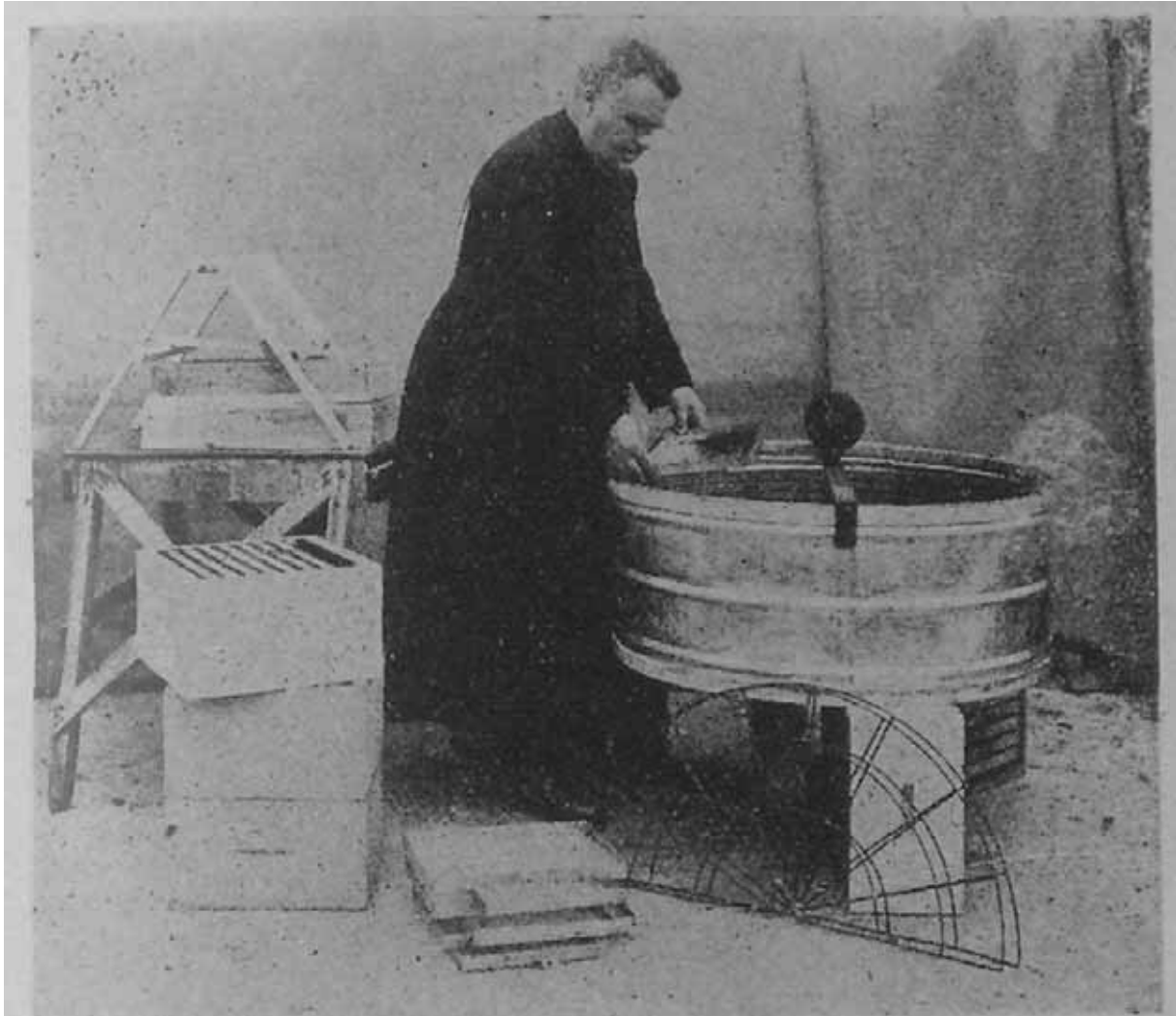
13°. L'opérateur place, à plat, dans l'extracteur, la grande cage support contenant le rayon, le haut du rayon tourné vers lui.
