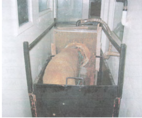
Photo 2. Cage à tête pour la collecte des gaz respiratoires
