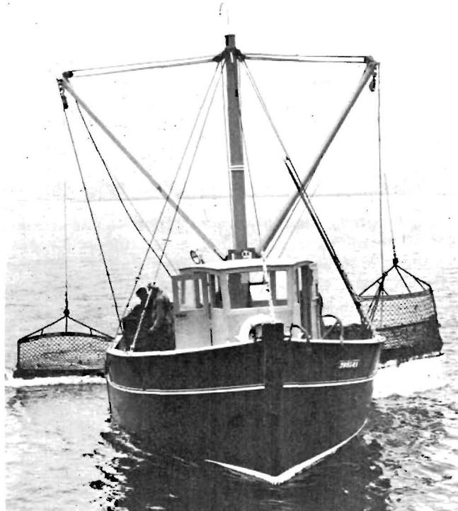
FIG. 43. — Bateau dragueur ; les deux dragues sont remontées et seront ouvertes au-dessus du pont (Morlaix ; photo MADEC).
