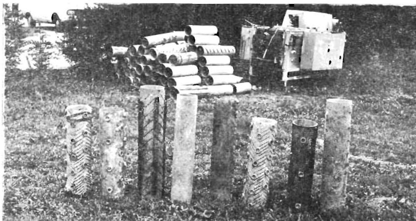
FIG. 85. — Tubes en plastique destinés à être enfilés sur des pieux supports : la photo montre quelques-unes des ornements (stries ou aspérités) qui ont été essayés.
