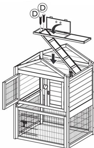
3. Posez le plancher intermédiaire, placez la rampe et fixez la à l'aide des vis.
