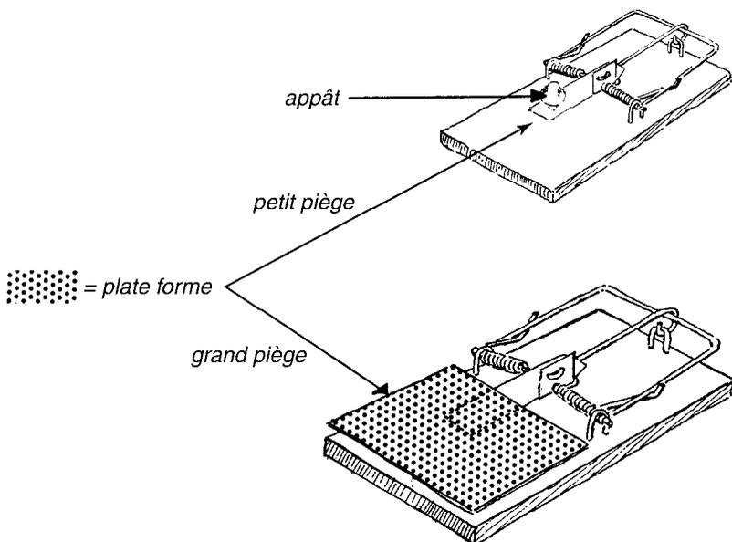
*Pour agrandir le piège, fixez sur la détente ou le porte-appât un morceau de métal fin ou de carton de  $4 \times 4$  cm.*
