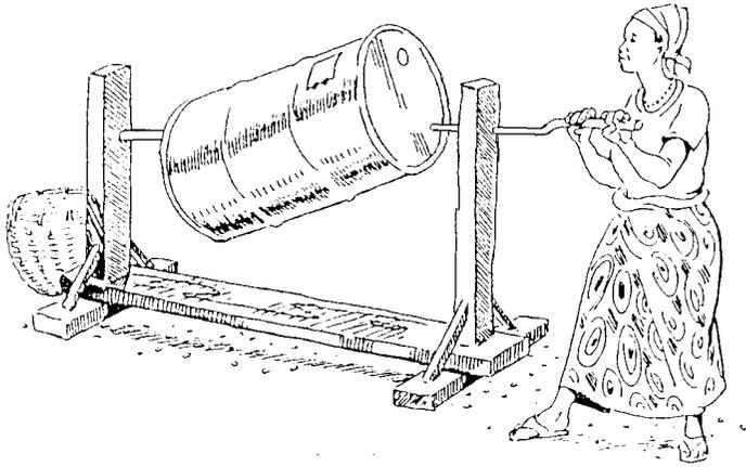
*Figure 17 : Equipement simple pour traiter les semences*
