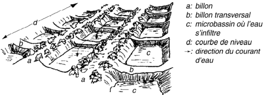
Figure 29 : Diguettes en damier légèrement inclinées par rapport à la courbe de niveau.
