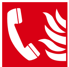
F024 Téléphone à utiliser en cas d'incendie
