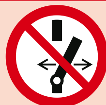
P031 Ne pas modifier la position de l'interrupteur
