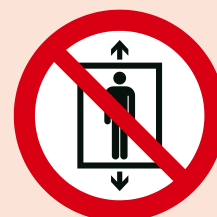
P027 Ne pas utiliser cet ascenseur pour des personnes
