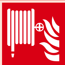
F002 Robinet d'incendie armé
