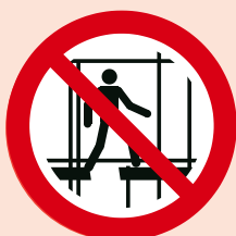
P025 Ne pas utiliser un échafaudage incomplet
