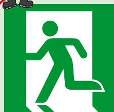
E001 Sortie de secours (à gauche)
