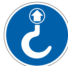
M243 Point d'ancrage obligatoire
