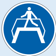
M023 Utiliser la passerelle
