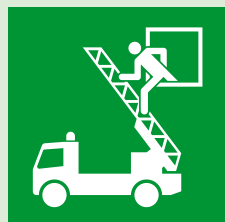
E017 Fenêtre de secours
