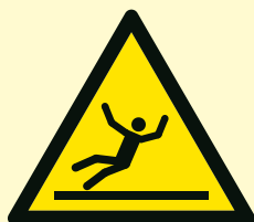
W011 Danger Surface glissante
