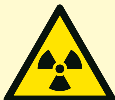
W003 Danger Matières radioactives ou radiations ionisantes
