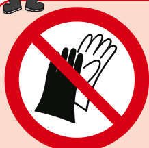
P028 Port de gants interdit
