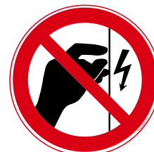
P152 Sous tension ne pas toucher
