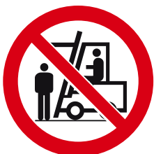
P200 Interdit de stationner sous la charge
