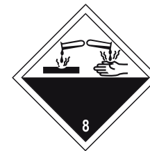
T118 Matières corrosives ou irritantes
