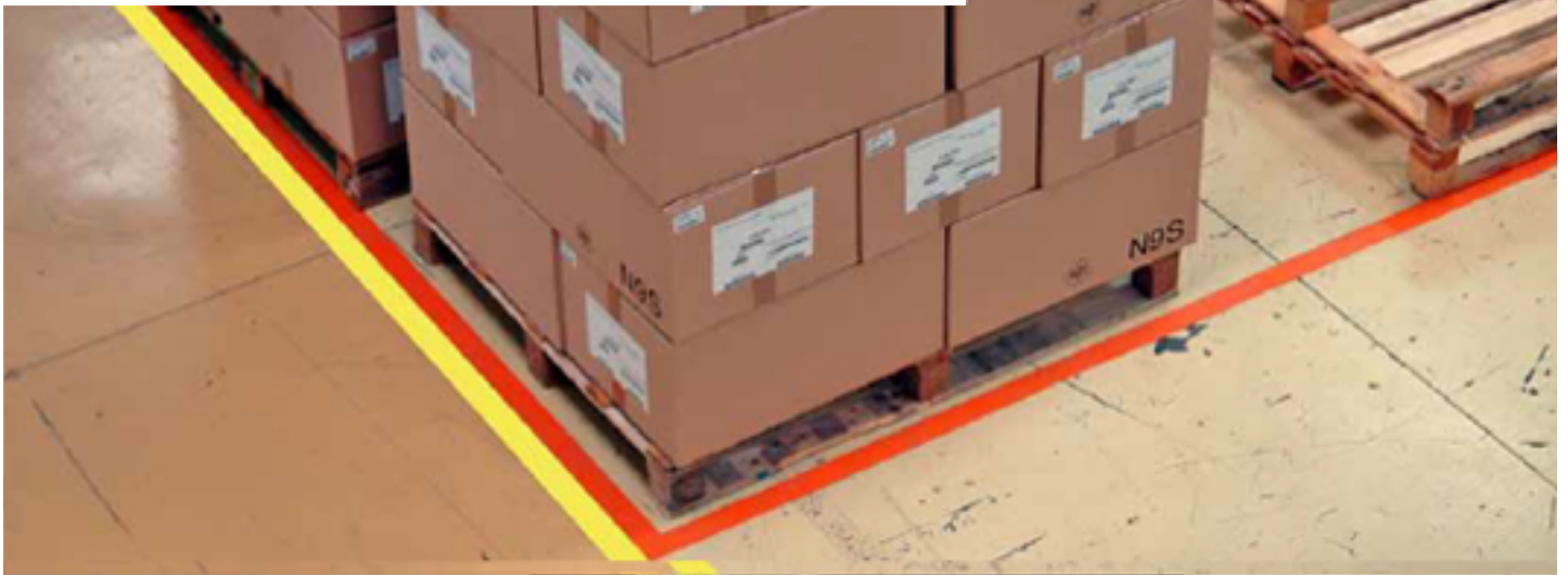
Signalisation des zones d'entreposage / zone de stockage
