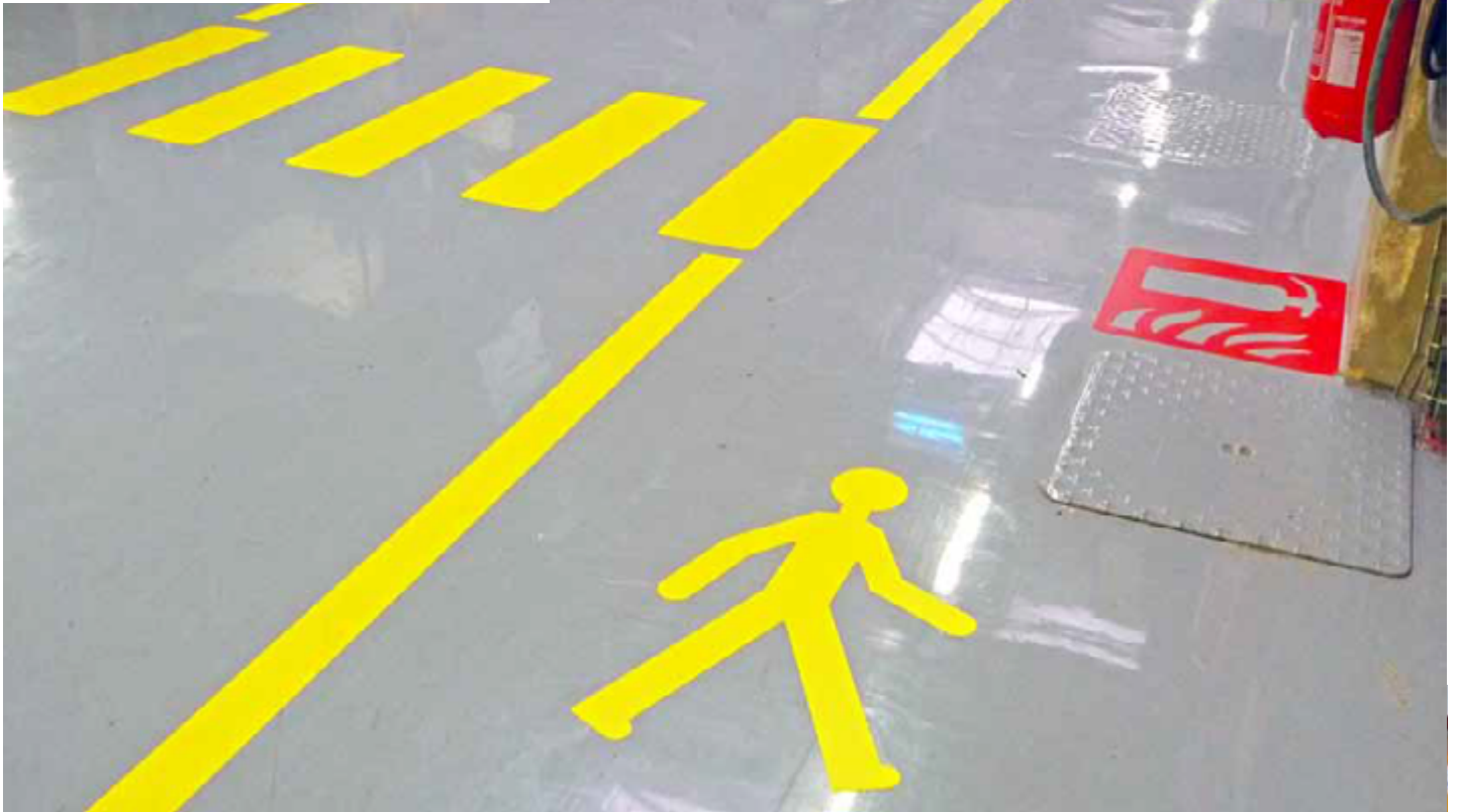
Signalisation des zones piétonnes
