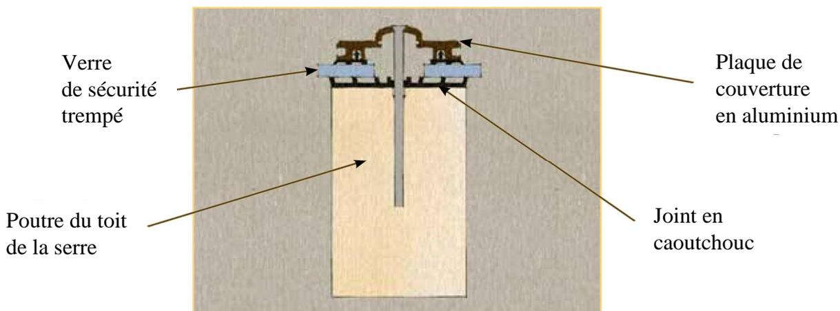
Grâce à notre système, le verre s'appuie sur le haut des poutres sur un joint en caoutchouc et il est maintenu en place dans la poutre par une vis en acier inoxydable qui traverse l'aluminium. Le joint en caoutchouc est étanche pour que la serre résiste aux intempéries.
