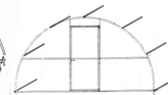
Schéma Armature et Pignon « Porte Simple Battant » de serre BIO 2 de 3.65 m de large
