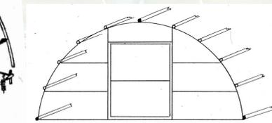
Schéma Armature et Pignon « Porte Simple Battant » de serre BIO 2 de 4.30 m de large
