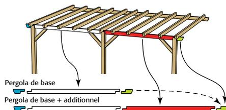
L'extension en profondeur se fait par le positionnement en quinconce des cavaliers, des modules de base et additionnel, sur les traverses.
