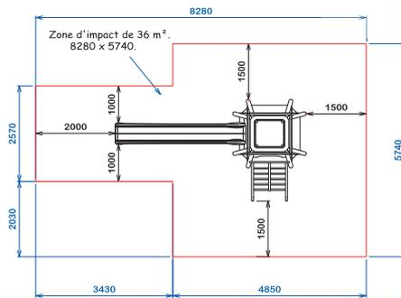
La zone d'impact doit être traitée en sol amortissant adapté à la hauteur de chute libre.
