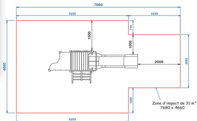
La zone d'impact doit être traitée en sol amortissant
