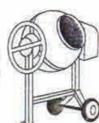
Pour une bétonnière électrique, vérifier que l'électricité arrive bien sur le chantier. Ne jamais graisser le pignon ou la couronne.
