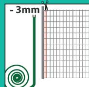
Recouper les lamelles d'extrémité dans le sens de la longueur - 3mm si utilisation du poteau primo
