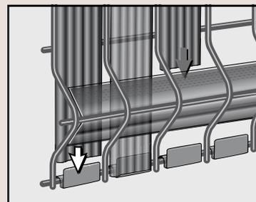
Glisser les lattes verticales à partir du haut du panneau en les positionnant derrière les profilés en «V», puis bloquer les lattes dans les clips comme spécifié sur le schéma. Placer ensuite les deux lattes verticales plus étroites sur les extrémités du panneau. Pour finir placer le profilé de finition sur le haut du panneau.
