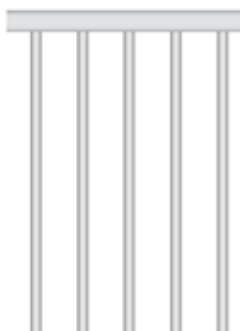
• Barreaudage non traversant
