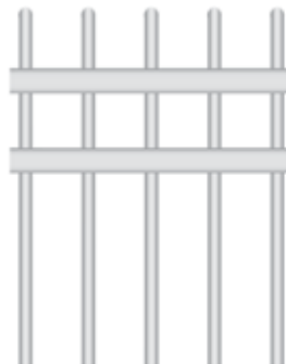
• Barreaudage traversant double lisse
