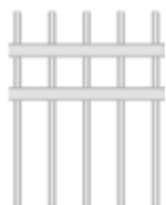
• Barreaudage traversant double lisse
