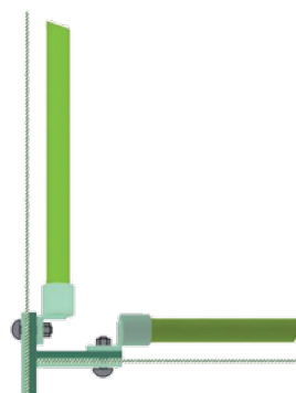
Pose sur tube de la bordure Muraille® (gestion des angles)
