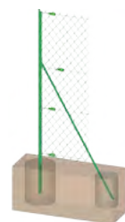
Piquet cornière de départ avec jambe de force, tendeurs, fil de tension et grillage Simple Torsion
