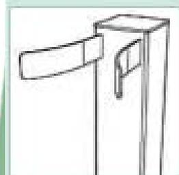
3. Colonne de fermeture : des supports pour l'ajustage dans la fermeture du portail
