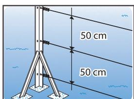
Les poteaux d'angles, les poteaux de reprise et les jambes de force doivent cependant être scellés dans le béton.
