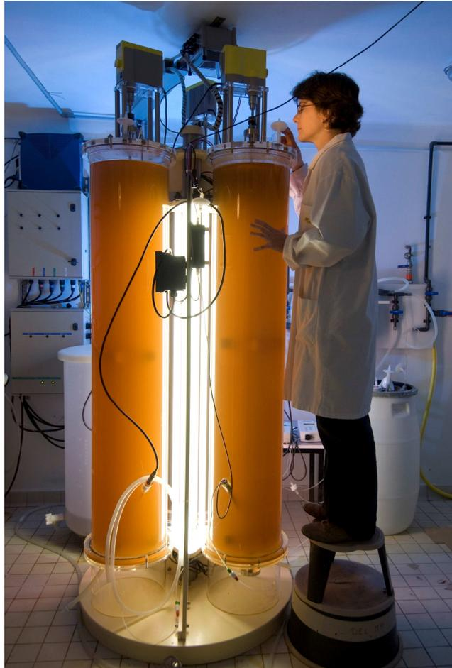
**Figure 4** : Photobioréacteur pilote IFREMER avec éclairage artificiel.
