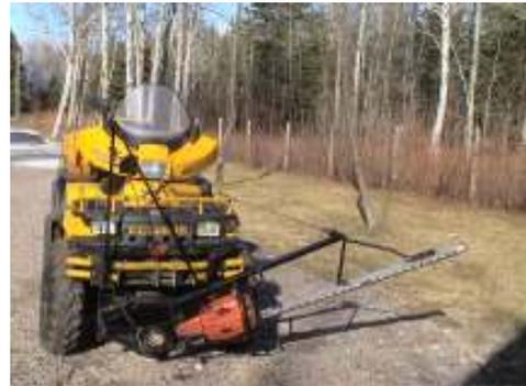
Scie mécanique montée sur VTT pour servir de débroussailleuse de côté
