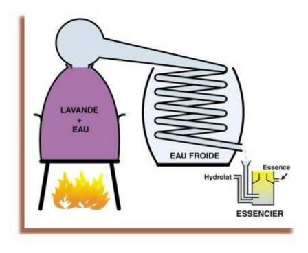
Capacité 100 500 de à litres Durée passée heures. de la environ 3 Combustible bois de pin de chêne, ou genêts. Les fleurs n'étant pas séparées de l'eau, elles ne peuvent être utilisées ensuite comme combustible.
