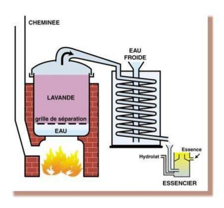
200 800 Capacité de litres. à Durée 2 3 de la passée de heures. Combustible paille distillée, bois, charbon. La cuve, dont le volume a augmenté, est protégée par une maçonnerie qui limite les pertes d'énergie. Utilisation du palan et du panier : ce dernier permet de séparer les fleurs de l'eau, et donc de les employer ensuite comme combustible.
