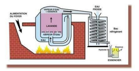
Capacité : généralement de 1 000 à 6 000 litres par vase (jusqu'à 20 000 litres). Durée de la passée : de 30 à 40 minutes. Combustible : paille distillée. Ces alambics à vapeur et bain-marie peuvent aussi fonctionner avec des chaudières à fuel ou au gaz. La majorité des distilleries est équipée d'alambics de ce type.
