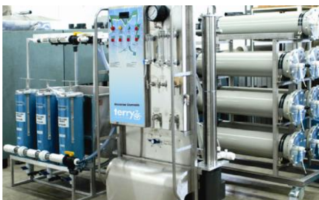
Installation d'osmose inverse pour la concentration délicate du gel d'Aloe Vera
