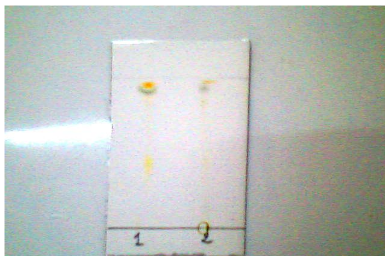
Figure 28. Photographie représentant la plaque chromatographique des lipides 1 et 2 dans le système S5( diéthyléther/ éther de pétrole : 2/1).
