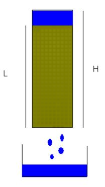
Perméamètre vertical. La longueur de la colonne de sol est L et la charge hydraulique est H. Lorsque la lame d'eau surmontant la colonne est très petite, H et L sont quasiment égaux, H/L, le gradient hydraulique est alors voisin de 1.
