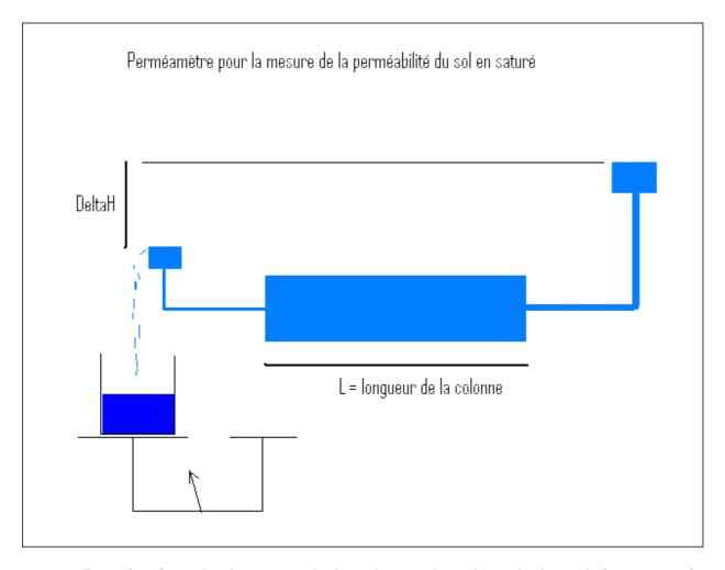
Perméamètre: La longueur de la colonne de sol est L. Le sol étant saturé d'eau, il a été représenté en bleu afin de montrer la continuité du cheminement de l'eau, même si l'eau ne circule pas par toute la section du sol à cause des solides).
