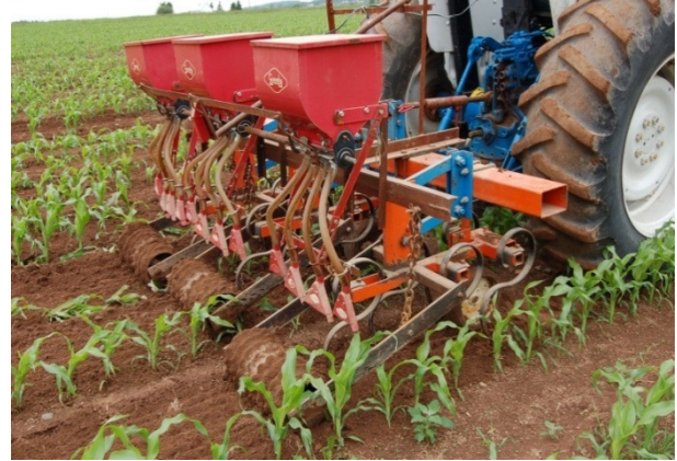
Semoir spécialisé pour cultures intercalaires (photo fournie par l'Association pour l'amélioration des sols et des cultures du Nouveau-Brunswick)
