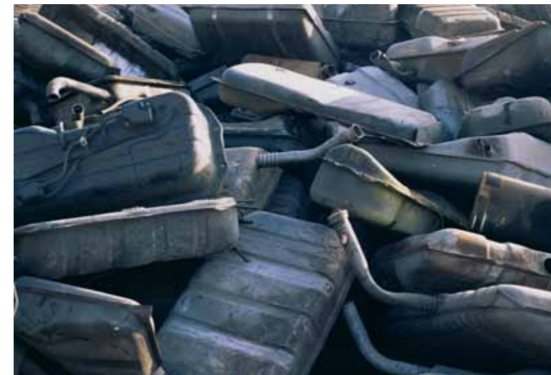
Le recyclage des pots catalytiques se justifie autant pour la dépollution que l'économie de matériaux. Leur teneur en métaux rares (platine, palladium, rhodium) est environ de 2kg/t contre 20 g/t en moyenne dans les minerais (15) .
