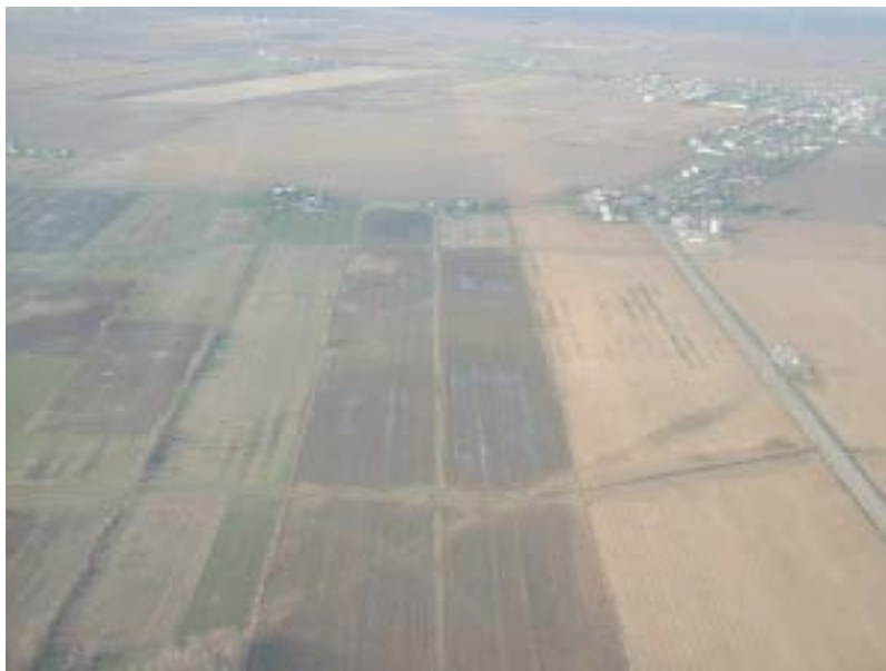
Figure 6 – Différence d'assèchement au printemps entre un champ non drainé (brun foncé, au centre) et un champ drainé (clair, à droite).
