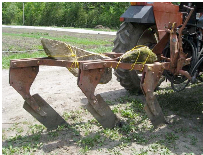
Figure 11 – Charrue modifiée en sous-soleuse
