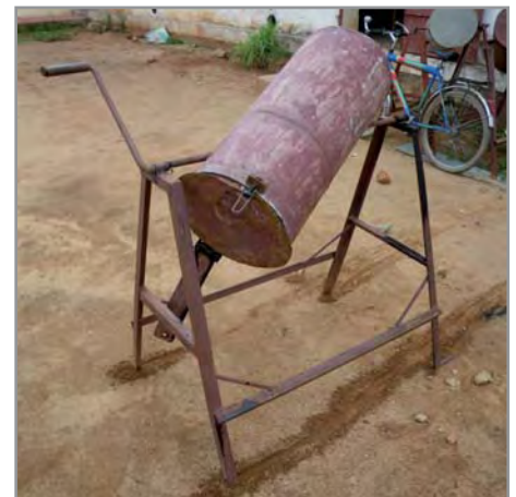
Tonneau mélangeur pour le traitement des semences Photo : F.X. Chabaud
