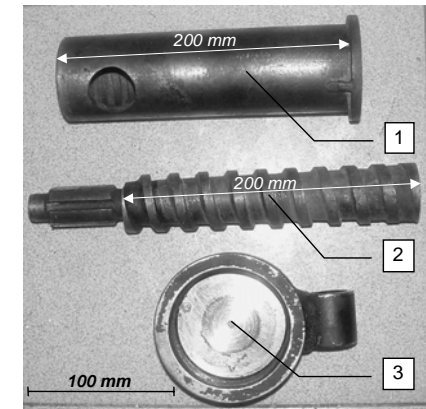
Figure 2: Pièces maîtresses du cuiseur-extrudeur très faible coût: 1. Fourreau; 2. Vis; 3. Filière.
