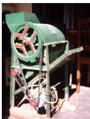
*Figure 5: broyeur mécanique à moteur électrique*
