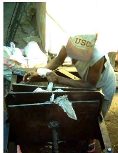
accrue de toiles filtrantes. Une variante de ce procédé consiste à desserrer la presse et à modifier la position de la masse à presser, puis effectuer un (ou plusieurs) nouveau(x) pressage(s). L'idée directrice de cette variante est en quelque sorte de permettre l'attaque de la masse à presser « sous tous les angles ».
