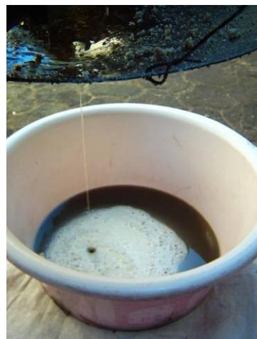
**Figure 8: huile brute\* s'écoulant de la presse**
