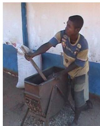
*Figure 2: décortiquage mécanique actionné manuellement*
