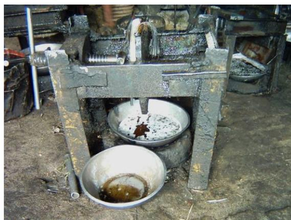
**Figure 6: presse artisanale à simple vis horizontale**
