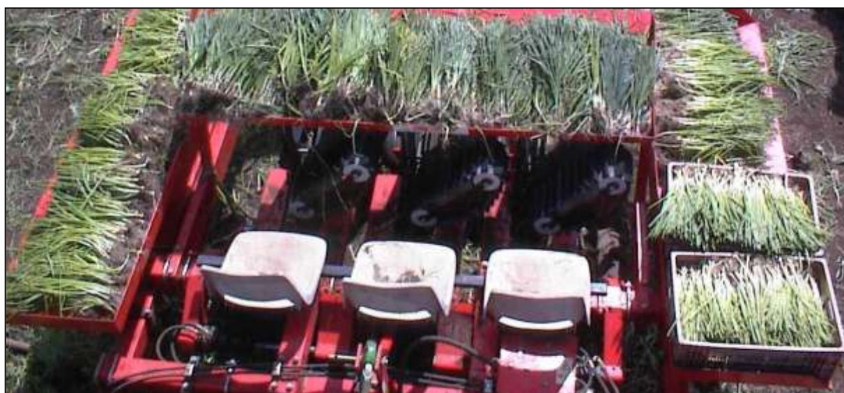
Photo 5 : Repiqueuse de plants 3 rangs Grégoire Besson. Ici les plants sont en racines nues. (Ravine des Cabris)
