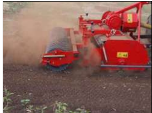
Photo 5 : enfouisseur de roche à l'action dans l'antenne IV
