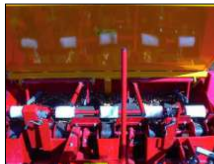
Photo 2 : Détail des brosses qui permettent de réguler le débit.
