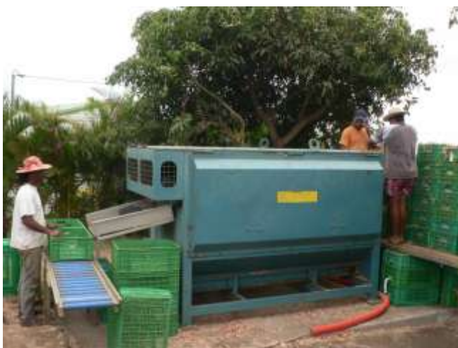
Photo 1 : Equeuteuse à deux hélices en action dans l'Antenne IV
