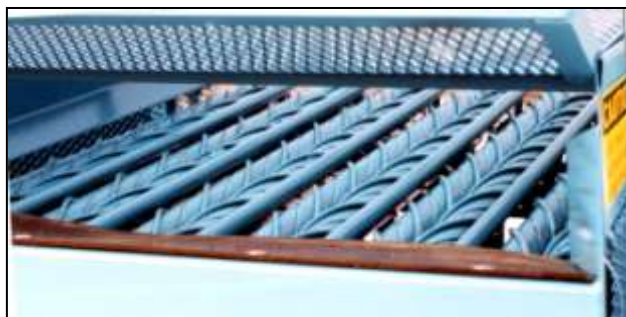
Photo 3 : Détail d'une équeuteuse à rouleaux
