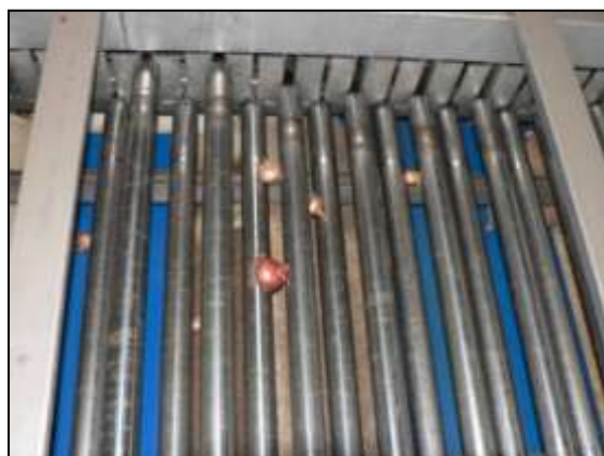
Photo 8 : Détail d'une calibreuse à rouleaux (Station Vivea Saint-Pierre)
