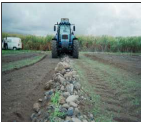
Photo 1 : le broyeur de roche peut pulvériser de petits andains de pierre (Saint-Joseph)
