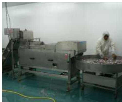
Photo 4 : Une machine entièrement automatique permet de couper les racines et le collet.
