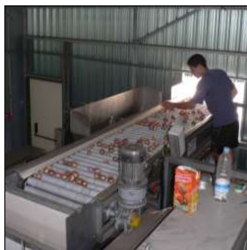
Photo 5 : utilisation d'un tapis de visite à la sortie de l'équeuteuse pour enlever les bulbes qui présentent des défauts. (Station Vivéa Saint-Pierre)
