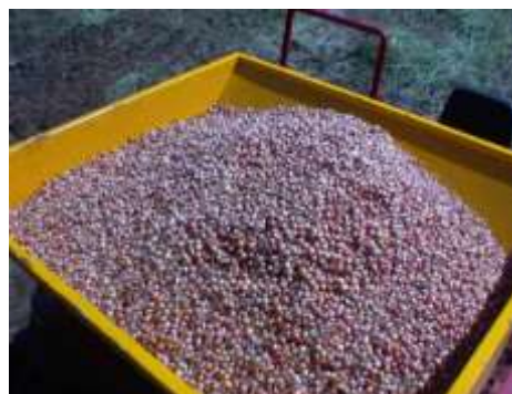
Photo 3 : Bulbilles bien calibrés placés dans la trémie de la planteuse Koning (Saint-Louis)
