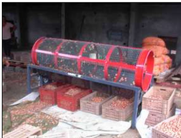
Photo 1 : Nettoyage et calibrage des bulbilles à l'aide d'une calibreuse à rouleau. (Saint-Louis)
