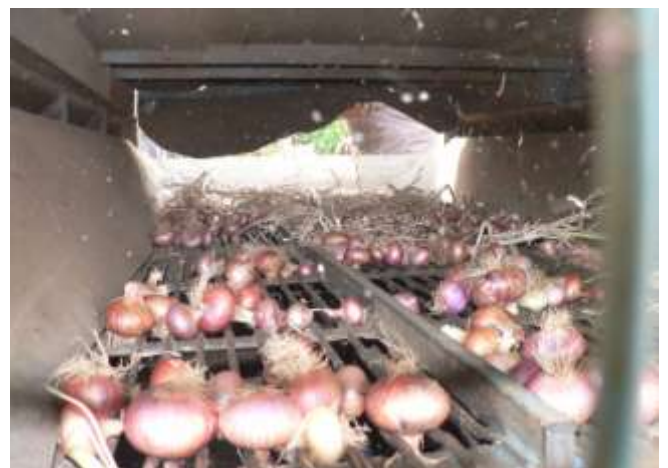
Photo 2 : Détail de l'intérieur de l'équeuteuse
