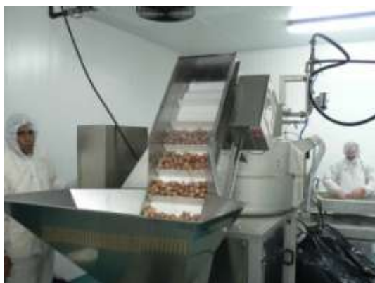
Photo 1 : L'oignon est placé dans une trémie et amené dans une éplucheuse à l'aide d'un tapis élévateur.
