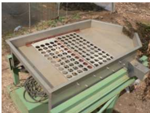
Photo 6 : Calibreur à grilles utilisé dans l'Antenne IV (Saint Gilles)
