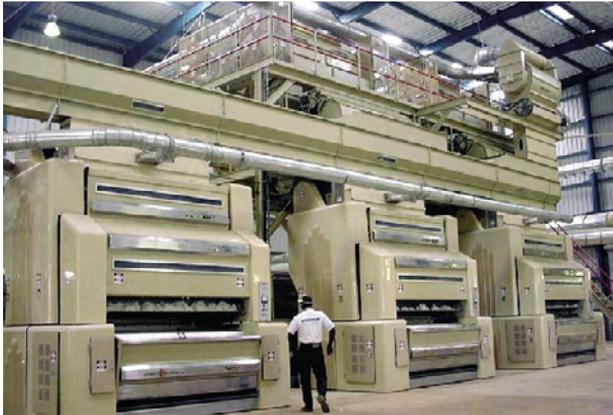
Figure 10. Trémies et gaines d'humidification du coton-graine au-dessus des alimenteurs. (Courtoisie CEC)
