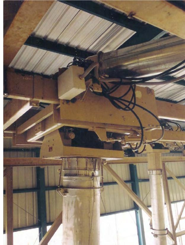
Figure 5. Tête mobile de télescope hydraulique.
