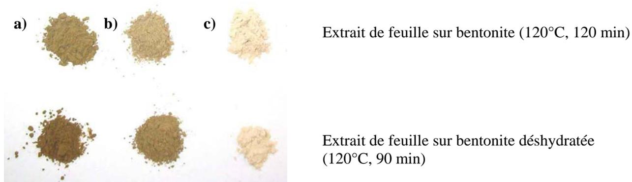
**Figure 20.** Néo-pigments à base d'extraits de feuilles et de bentonite *a)* avant suntest, *b)* après suntest (8h00) et *c)* argile seule, bentonite.
