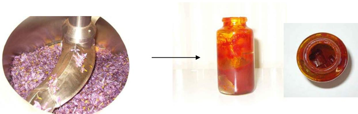
**Figure 9. Matière végétale (fleurs fraîches) introduite dans le réacteur et extrait végétal obtenu après macération, filtration et concentration à sec.**
