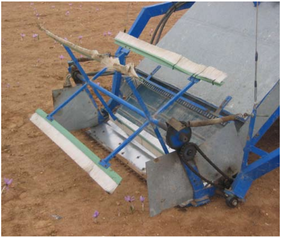
Machine pour la récolte des fleurs de safran (photo ITAP)
