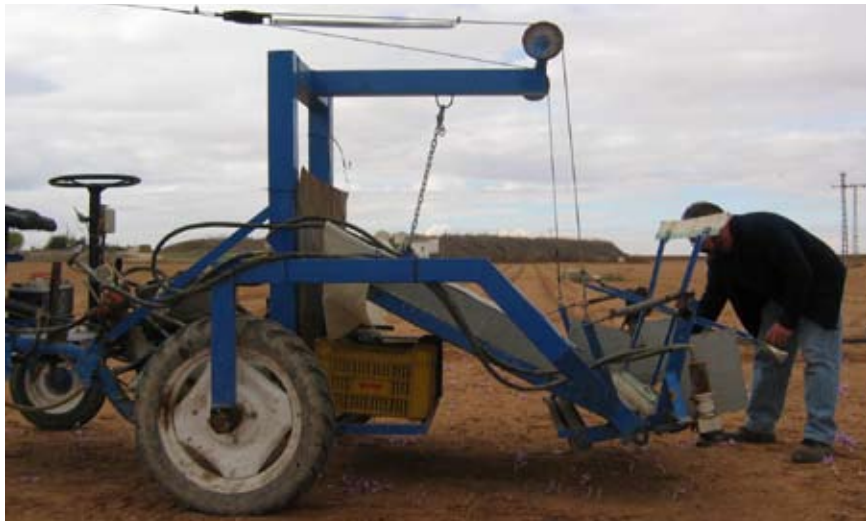
Figure 6. Machine pour la récolte des fleurs de safran
