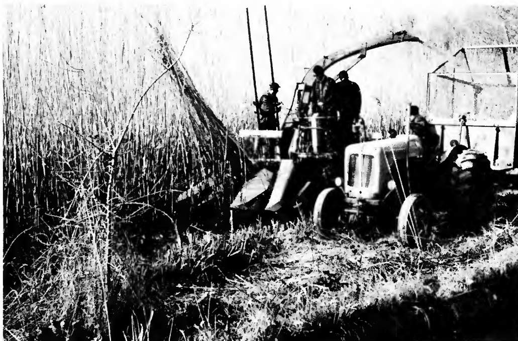
Premiers essais de récolte mécanisée de canne à sucre de Provence avec une ensileuse maïs.
