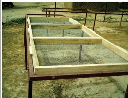
Des prototypes de claies de séchage horizontales surélevées à 1,10 m du sol avec des supports métalliques et des supports en bois ont été proposés en substitution des claies de séchage de fortune à même le sol. Les supports de longueur 12 m et de largeur 2 m peuvent recevoir 22 claies démontables d'une capacité moyenne de 12 kg de poisson par claie.
