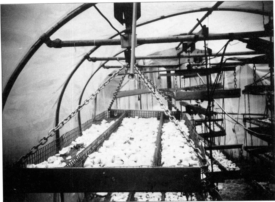
Fig. 4. L'imposante charpente interne du sêchoir expêrimental -- claie remplie de manioc.
