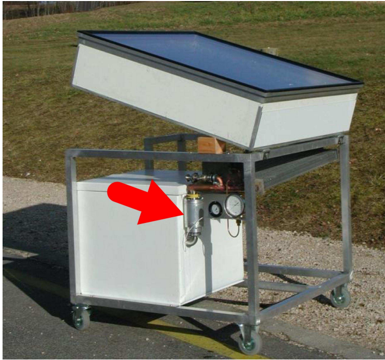
FIG. 6 – Vanne autonome testée pour la première fois sur le réfrigérateur transportable.
