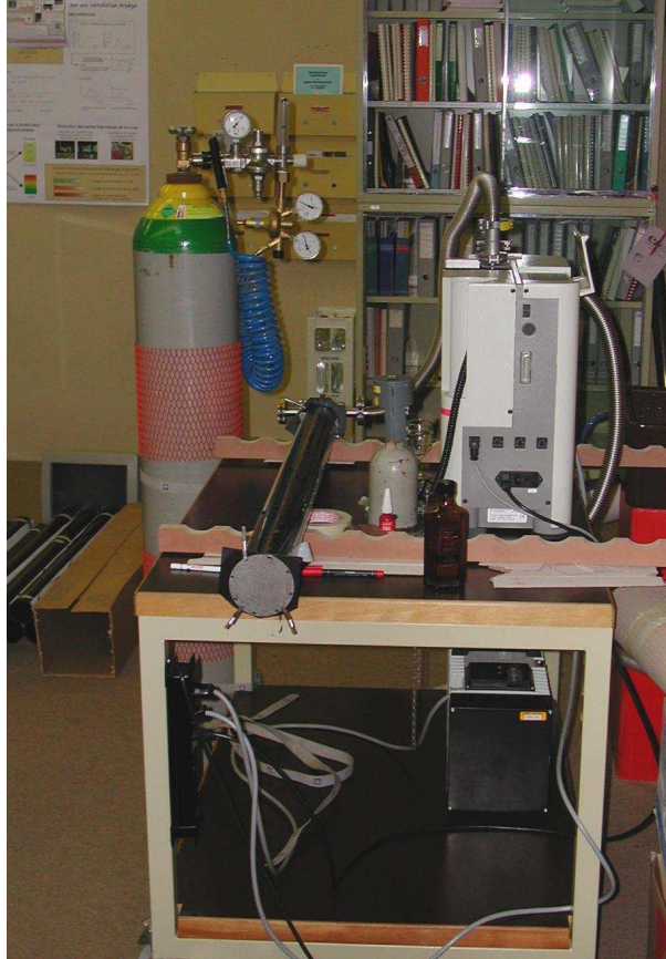
FIG. 9 – Stand de détection de fuites avec détecteur à hélium.
