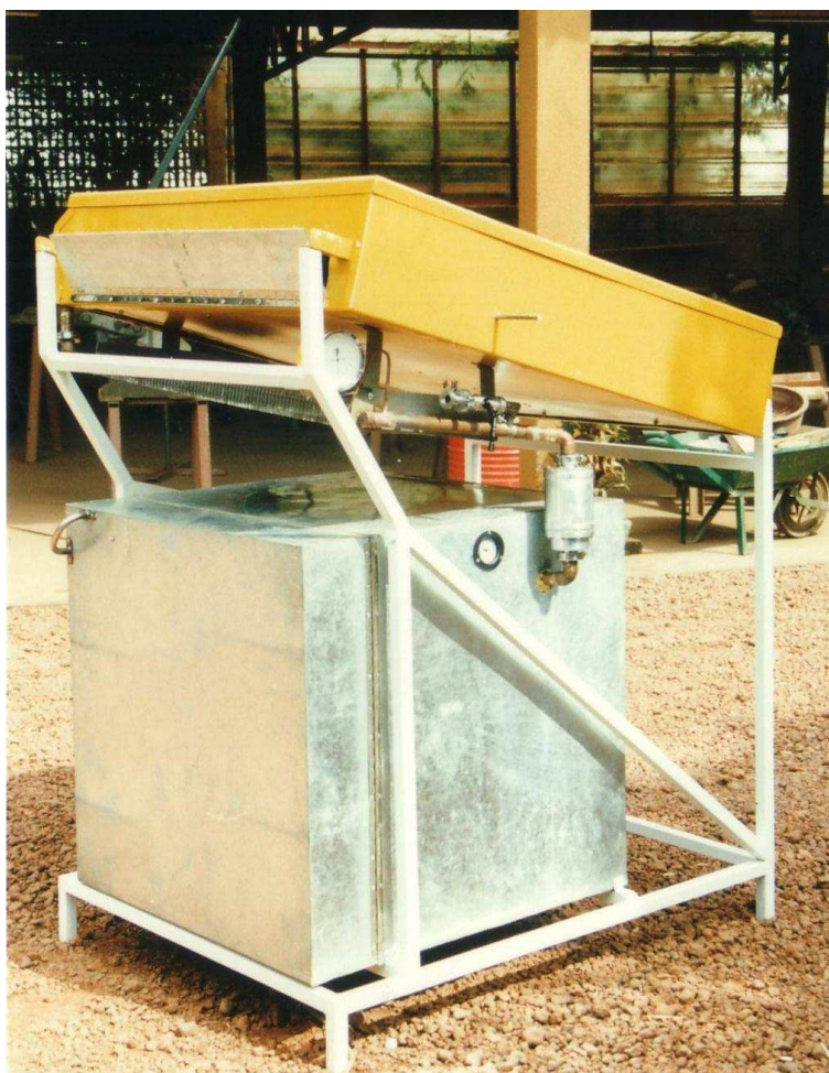
FIG. 14 – Premier réfrigérateur solaire à adsorption entièrement fabriqué au Burkina Faso
