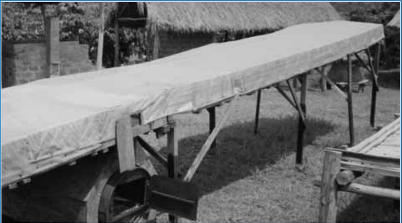
FIGURE 6 Un séchoir combiné, solaire et à combustible. (Photo de l'auteur)
