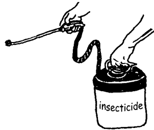
Vaporisateur à air comprimé avec pompe à piston
