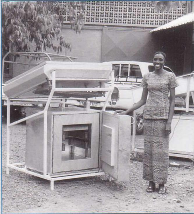
Figure 5. Prototype "made in Burkina", système avec capteur-adsorbteur à tubes, silicagel-eau, 1 m<sup>2</sup> de capteur solaire et 80 litres de volume réfrigéré.
