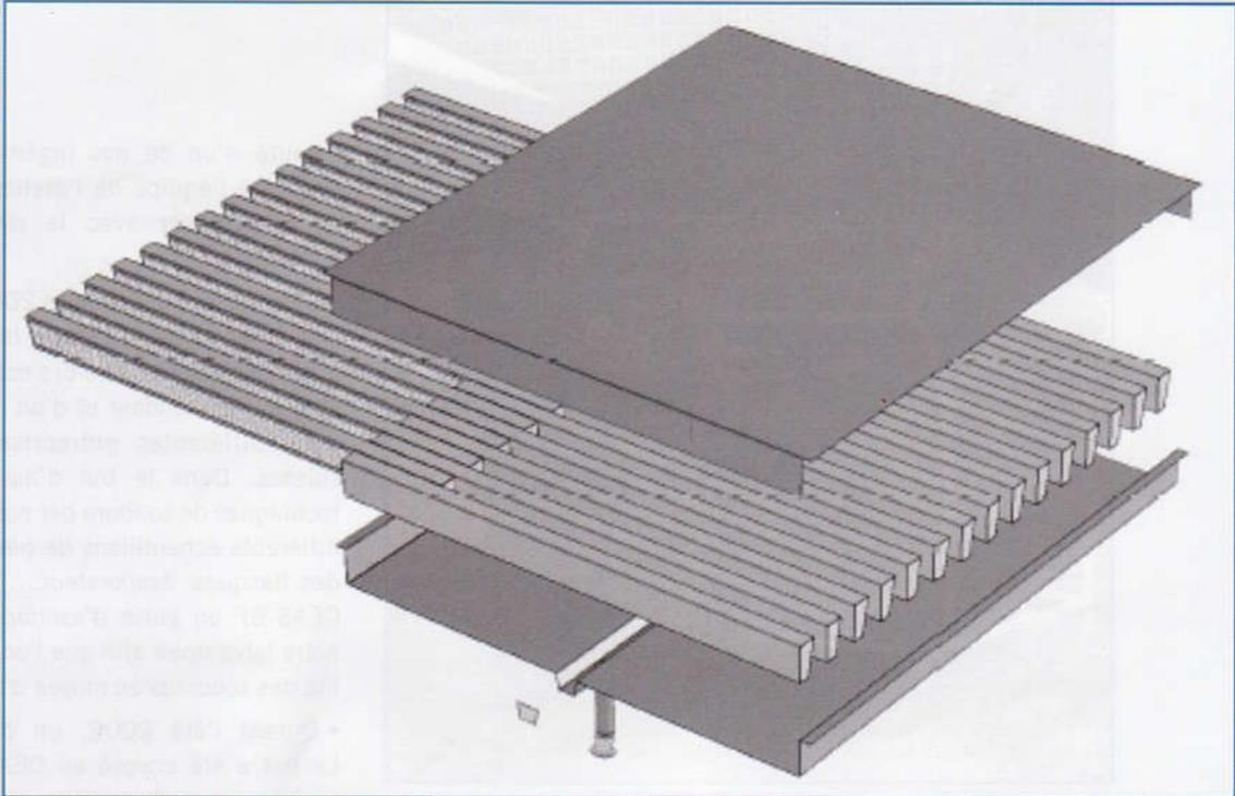
Figure 4. Vue éclatée du capteur-adsorbeur plan.
