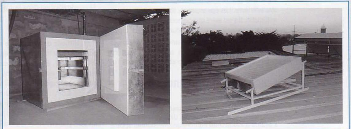
Figure 6. Prototype construit par le CEAS-BF. Le capteur-adsorbteur solaire (1m<sup>2</sup>) se trouve sur la toiture et l'enceinte frigorifique (80 litres) est à l'intérieur du bâtiment.
