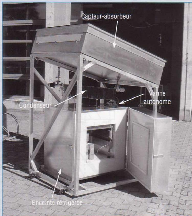
Figure 1. Vue d'ensemble du réfrigérateur solaire à adsorption développé par le Lesbat (réfrigérateur testé dans un centre de santé en Erythrée dès l'automne 2005).
