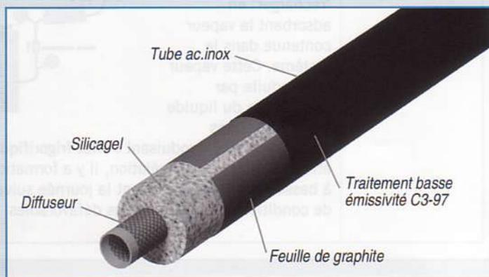
Figure 3. Détail de construction d'un tube.
