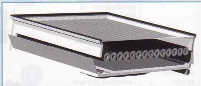
Figure 2. Vue du capteur-adsorbeur à tubes.
