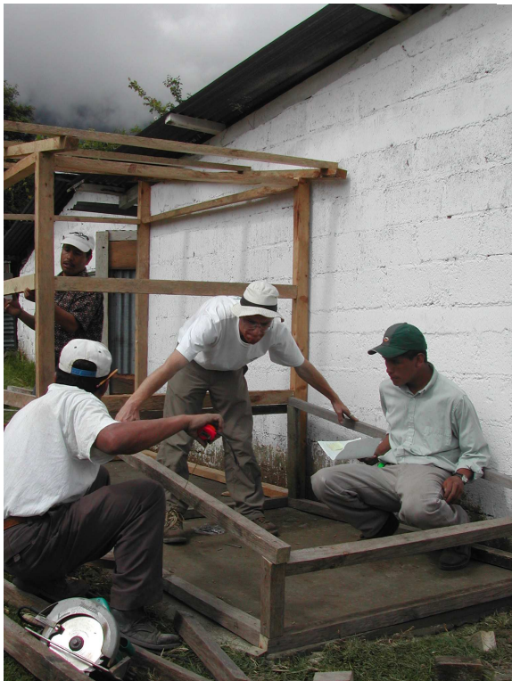
Fabrication des clayettes (tamis fin en plastique et cadre en bois)
