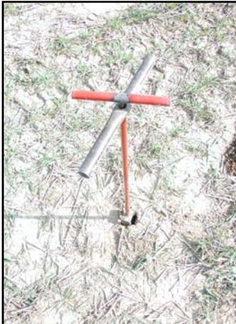
**Figure 2 :** Sonde de prélèvement
