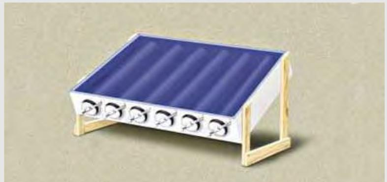
L'inclinaison du collecteur est très importante, elle conditionne la bonne efficacité du système. La caisse doit être inclinée de dix degrés de plus que la latitude du lieu où est installé le collecteur.
