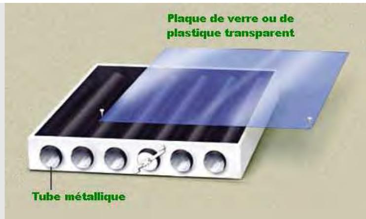
Les tubes peuvent être fixés à l'aide d'une colle à base de silicone
