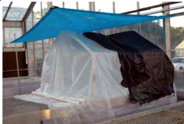
Exemple de chambre humide faite de tubes en PVC et de films plastiques transparents et opaques
