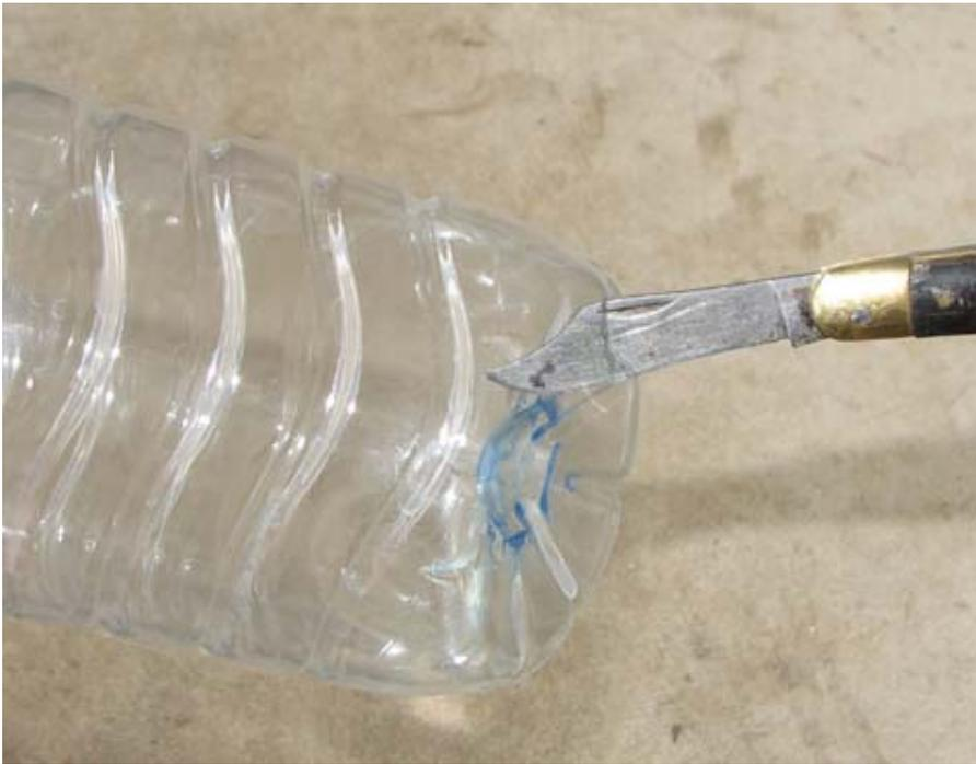
Et de la pointe du couteau, un petit trou d'aération dans la partie supérieure de la bouteille, à proximité du goulot :
