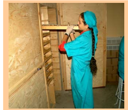
Photo 12 : Mise des claies dans le séchoir
